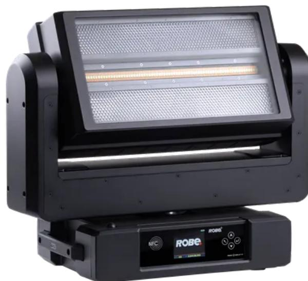
Er hat drei unabhängig steuerbare, schnelle, motorisiert zoombare Module - einschließlich eines einzigartigen Hyper-Z™ Zooms für das Stroboskop in der Mitte, der weltweit erste lineare motorisierten Zoom von 98 x 14° bis 125 x 97°. Die beiden äußeren Modulen mit je acht 60 Watt RGBW-LEDs haben einen 13°-95°-Zoom und können sowohl helle Washes als auch intensive Beams erzeugen.
